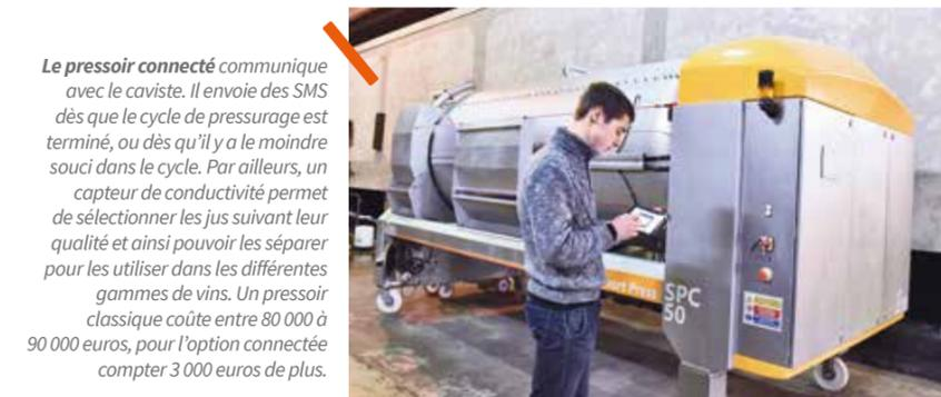
Le pressoir connecté communique avec le caviste. Il envoie des SMS dès que le cycle de pressurage est terminé, ou dès qu'il y a le moindre souci dans le cycle. Par ailleurs, un capteur de conductivité permet de sélectionner les jus suivant leur qualité et ainsi pouvoir les séparer pour les utiliser dans les différentes gammes de vins. Un pressoir classique coûte entre 80 000 à 90 000 euros, pour l'option connectée compter 3 000 euros de plus.
