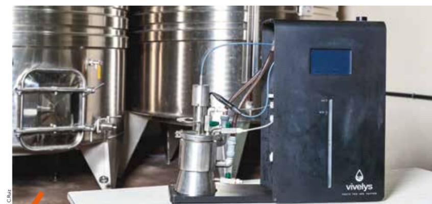
La transformation du jus de raisin en alcool est un processus gourmand en oxygène. C'est une opération délicate qui demande beaucoup de temps et d'attention. La cuve connectée gère de manière autonome ce processus qui dure entre trois et quatre jours. En injectant de l'oxygène au fil de la fermentation et en réfrigérant automatiquement la cuve, dès que sa température s'élève de +0,3°C. Une cuve connectée garantit une cuvée réussie !
