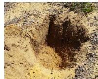
Dig a test hole
