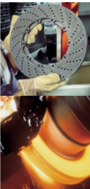
Bild oben: Carbon-Keramik- Bremsscheiben- fertigung Bild unten: Keine nachlassende Bremswirkung (Fading) auch unter extremer Belastung
