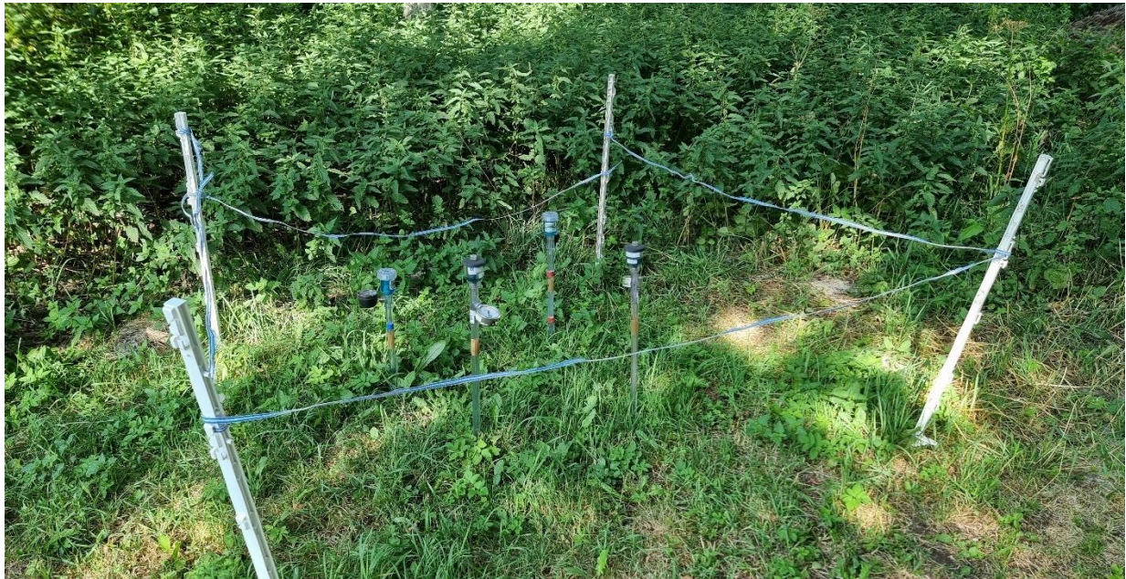
Foto 19: Tensiometer-Station zur Überwachung der Bodenfeuchtigkeit (Matthias Schlegel / Twister)
