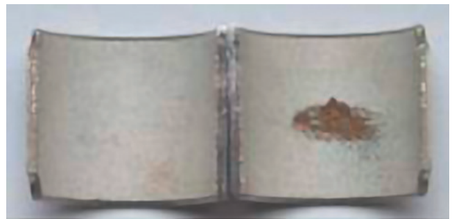
Abb. 35: Örtlicher Schaden durch Kavitation
