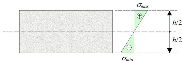
9. ábra. A hajlítás következtében megjelenő feszültség
