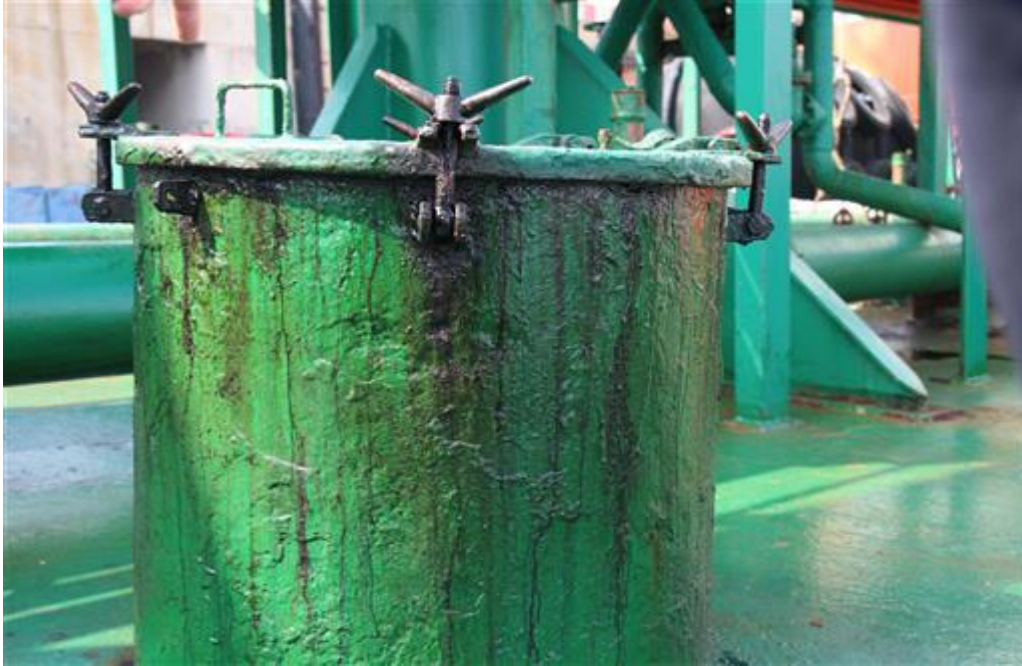
图 6：发生冒油的左三货舱小舱口
