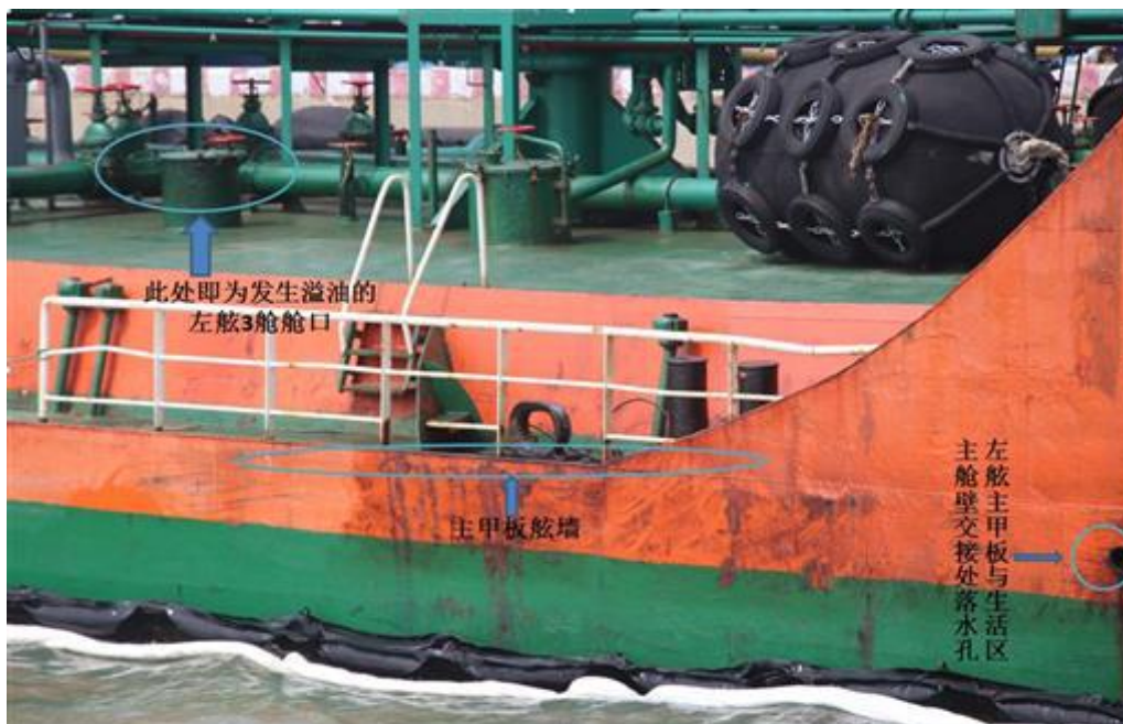
图 7：溢油现场情况
