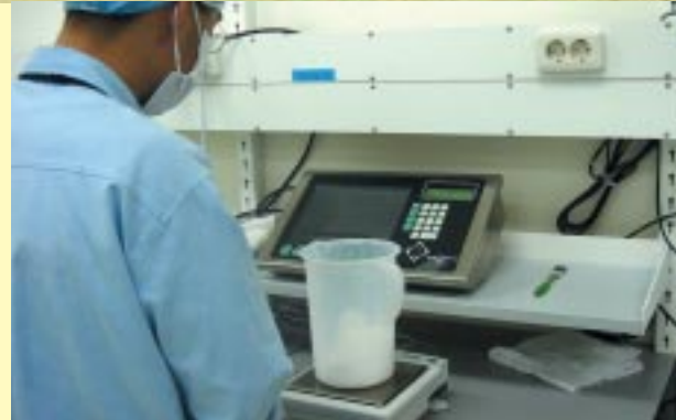
Bediener am Rezeptverwiegen auf einer PR-Waage mit ID20 Terminal.
