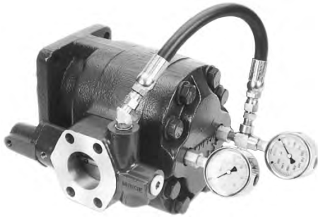
Las bombas diseñadas para alojar cómodamente manómetros de vacío y presión ahorran tiempo de mantenimiento y ofrecen mayor precisión. Los puertos traseros especiales de prueba que aparecen en esta vista de Muncie Powr-Pro se pueden usar para el monitoreo del rendimiento. Las bombas de cuatro puertos, dos sentidos (Series K y L) también son muy accesibles para las instalaciones de los indicadores.
