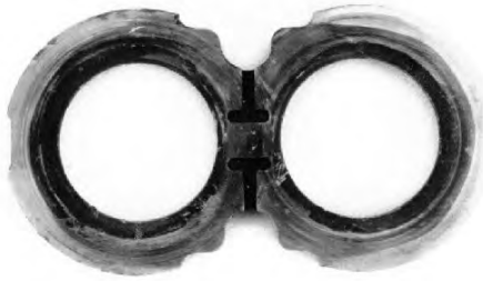
Placa de desgaste que muestra los efectos del recalentamiento.
