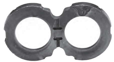
Placa de desgaste con picaduras por cavitación
