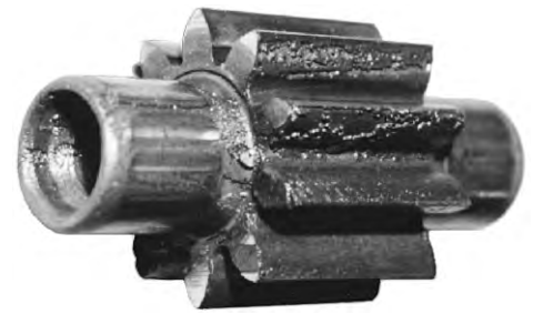
Este engranaje fue dañado por el concentrado de jugo de naranja que entró al sistema hidráulico.
