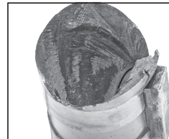
Falla del eje debido a cargas cíclicas.
