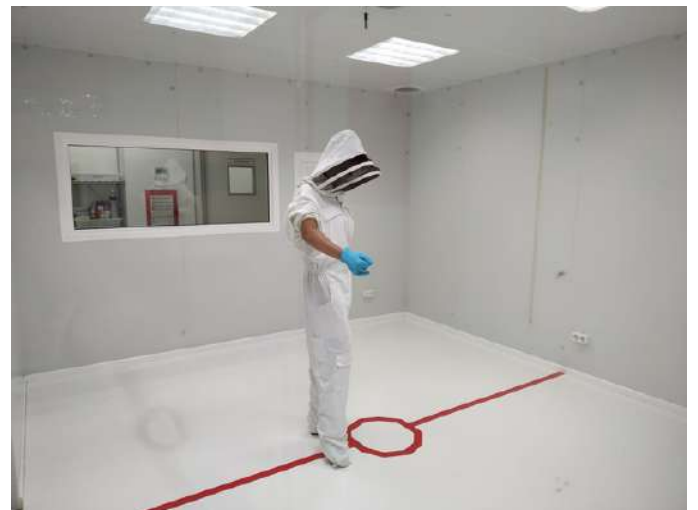
Imagen 1. Evaluación de repelentes espaciales contra insectos hematófagos mediante ensayos de simulación en cabina de 30m3.
