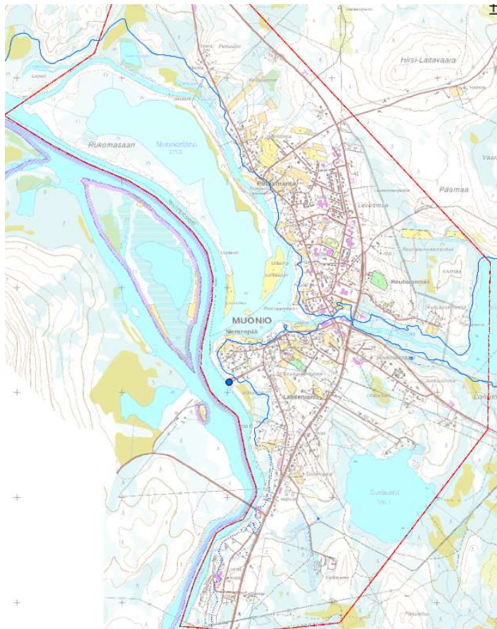
Kuva 26. Muonion vedenkorkeusaseman kerran 100 vuodessa toistuvaa tulvavedenkorkeutta vastaava korkeustaso perustuen 10x10 m korkeusmalliin.
