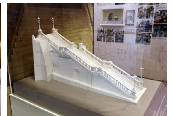
24 利用三維打印技術製作標示了編碼的花崗石碎片的微縮打印，重組成完整的古蹟模型。 Model of the reassembled Monument using the 3D-printed miniature replicas of the numbered granite fragments
