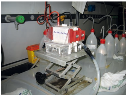
Figura 4: Corsa in atto di SDS-PAGE per activity staining su una unità SE260.
