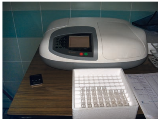
Figura 3: Lo spettrofotometro e il porta-cuvette utilizzati per i saggi enzimatici.
