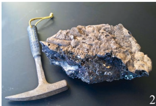
Figura 2: 1) Capattoli (Campiglia Marittima): cumulo di scorie raccolto durante una ricerca; la colorazione esterna rivela una buona mineralizzazione, (foto Bonotti). 2) Madonna della Fucinaia (Campiglia Marittima): una grossa scoria parzialmente fratturata con presenza di bollosità colorate dovute a minerali di rame e piombo, (foto Bonotti).
