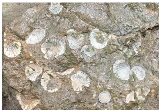
Figura 6: Bozza di arenaria volterrana denominata panchina contenente gusci fossili di molluschi lamellibranchi della famiglia dei Pettinidi.
