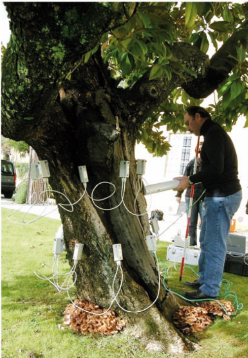
Figura 3: Magnolia in villa privata a Lucca (2007). Vista generale: si noti la forte inclinazione e l'abbondante presenza di basidiocarpi di Armillaria al colletto. Sono visibili i sensori del tomografo sonico, mentre l'operatore sta azionando il dendropenetrometro.
