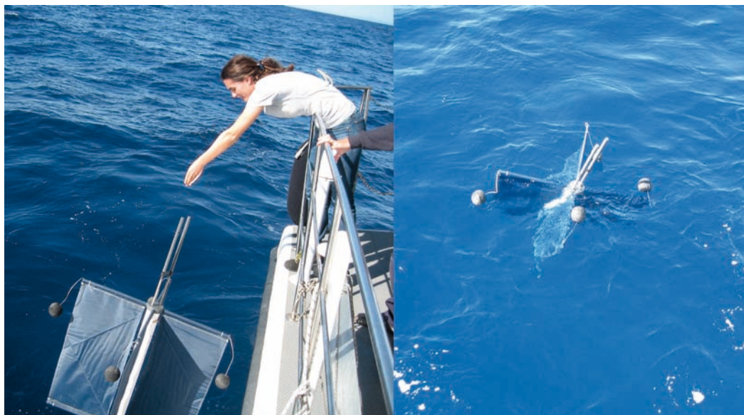
Figura 5: Messa a mare di un drifter.
