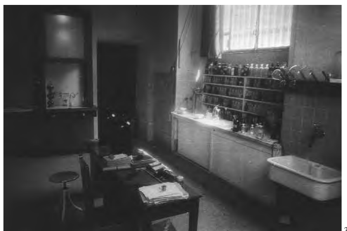
Figg. 2-3. Musei Vaticani, Gabinetti Ricerche e Applicazioni Scientifiche (1935-1940). 2. Locale per l'analisi chimica e microscopia (banco con microscopio monoculare Carl Zeiss, scaffalatura con reattivi, piano di lavoro); 3. locale per l'analisi chimica e microscopia (sulla parete di fondo si nota la presenza di cappe con apparecchio di Kipp per la produzione di idrogeno solforato).
