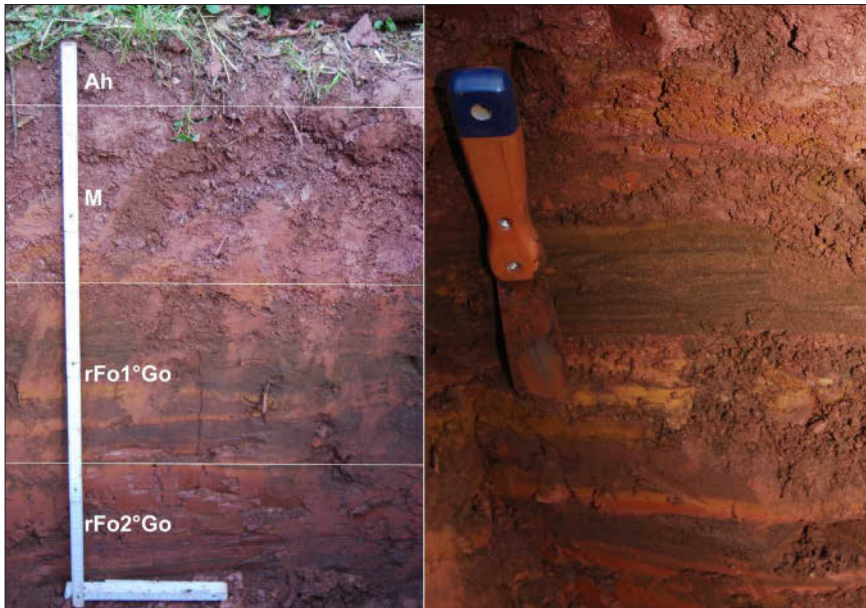
Abbildung 10: (l.) Vergleichtes anthropogenes Spül- bzw. Schlammsediment, ehemalige Absetzbecken Klingelbachtal; (r.) Detailaufnahme: tonig und sandige anthropogene Sedimentlagen, ehemalige Absetzbecken Klingelbachtal; Foto: Collin Weber.
