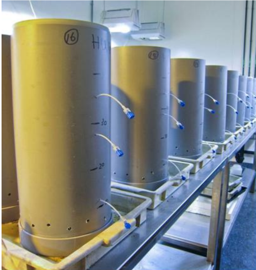
Figuur 4.2. Overzicht van de kolommen waarin het verzuringsexperiment wordt uitgevoerd (okt. 2007)
