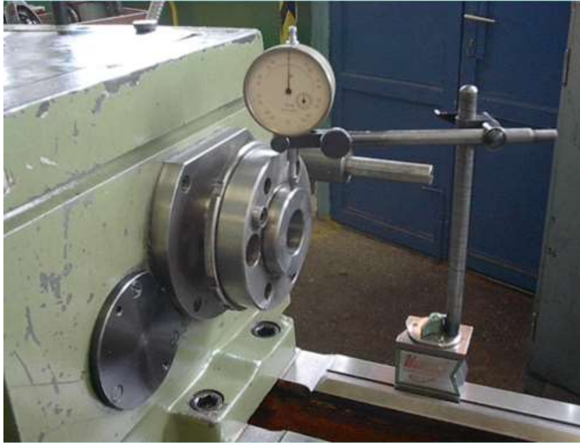
Kúpos központosító felület ellenőrzése
