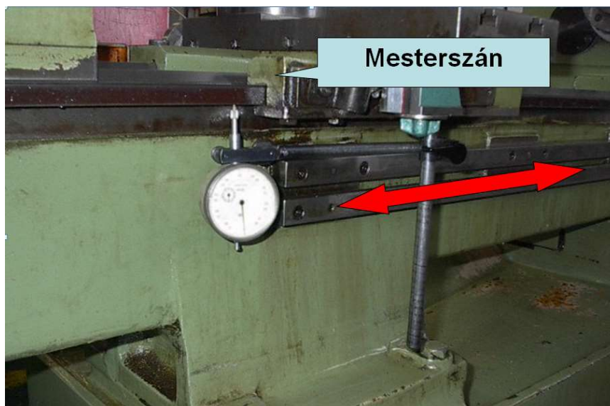
Az ágyvezeték alsó lapjának pontossági mérése
