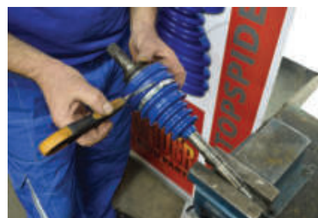
12. CUT THE CV BOOT TO APPROPRIATE DIMENSIONS / Iseci manžetnu na odgovarajuću dužinu
