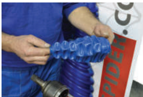
5. ROLL OVER (UPTURN) THE CV BOOT / Manžetnu prevrnuti
