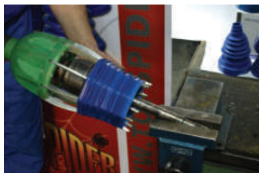
4. ROLL OVER / Prebaciti manžetnu preko homokinetičkog zgloba na poluosovinu
