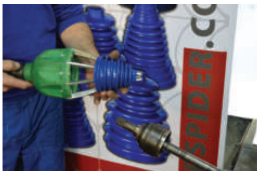
1. CONNECT THE TOOL TO THE COMPRESSOR / Uključiti aparat za montažu na kompresor i staviti manžetnu na aparat
