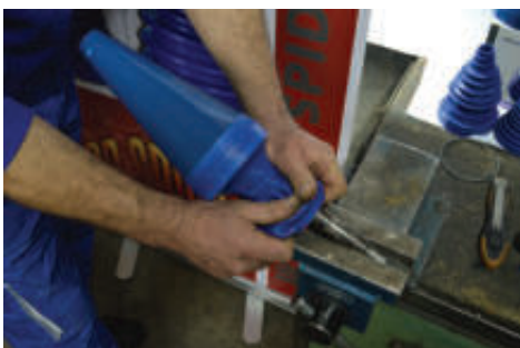
9. THROW OVER THE JOINT / Prebaciti manžetnu preko HKZ na poluosovinu
