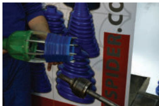
2. SWITCH ON THE TOOL AND HOLD UNTIL THE CV BOOT OPEN ENOUGH / Uključiti aparat za montažu da se manžetna (rastegne) raširi
