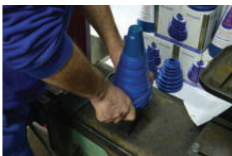
7. START TO PULL THE BOOT OVER THE SLIDER / Manžetnu početi navlačiti na levak
