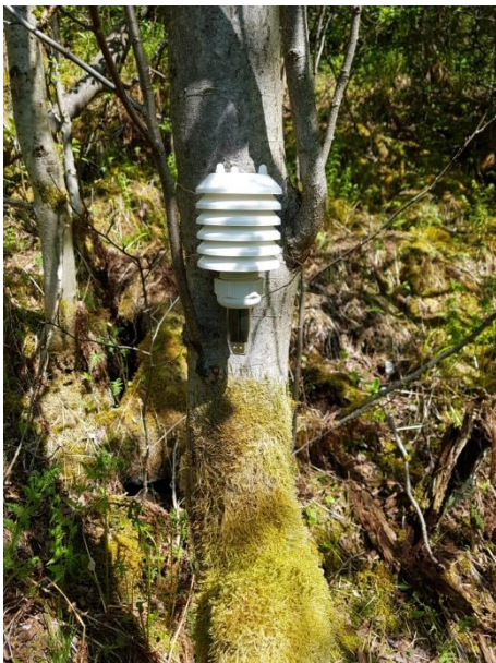
Figur 22. Datalogger med sensorer for måling av relativ luftfuktighet og lufttemperatur montert i solskjerm på trestamme i skogrute. Foto: H. Bratli.
