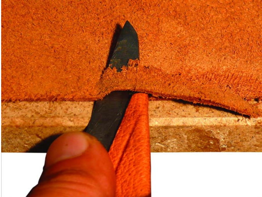
19. ábra. Szélvékonyítás késsel
