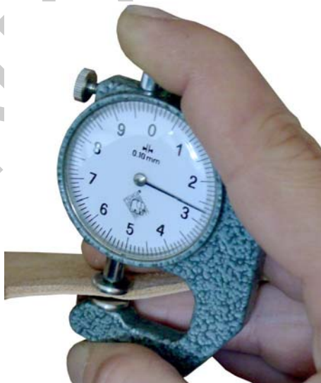
8. ábra. Ellenőrzés rugós vastagságmérővel
