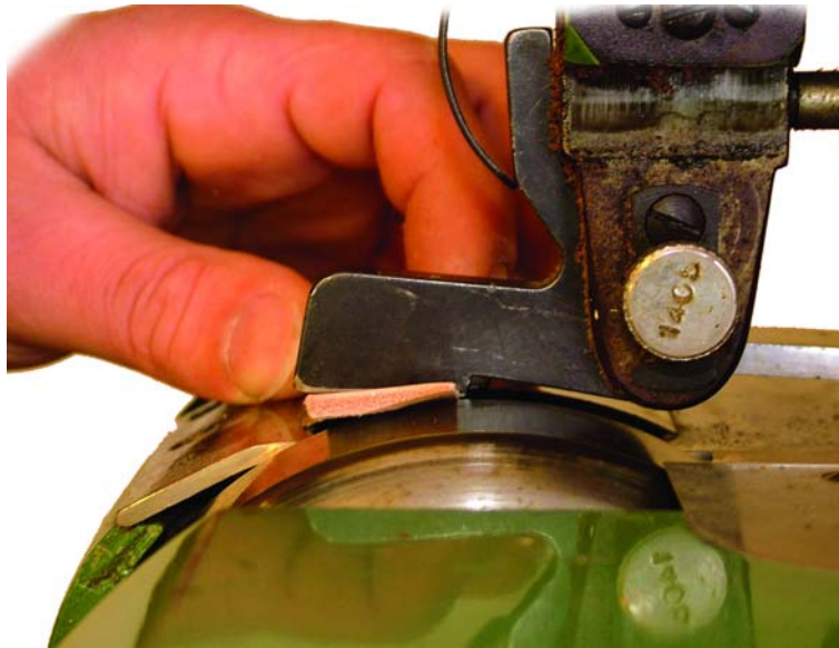
23. ábra. Ék alakú vékonyítás harangkéses élezővel
