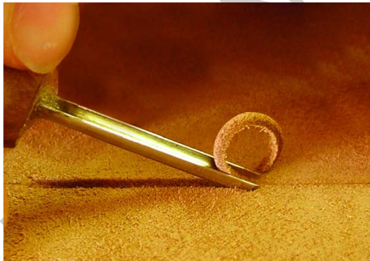
33. ábra. Közkiemelés linómetszővel
