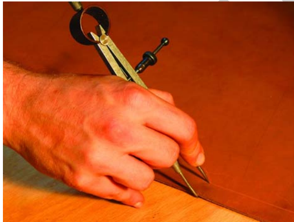
2. ábra. Párhuzamos húzása jelölőkörzővel
