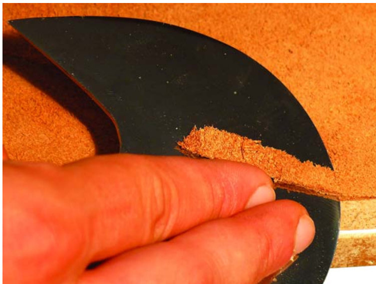
20. ábra. Szélvékonyítás félholdkéssel
