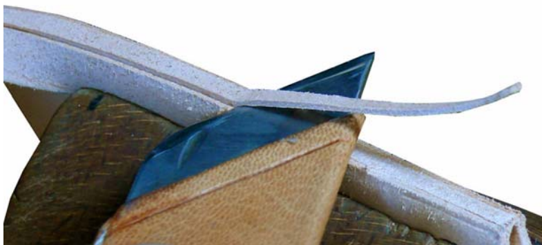
34. ábra. Közkiemelés bemetszéssel
