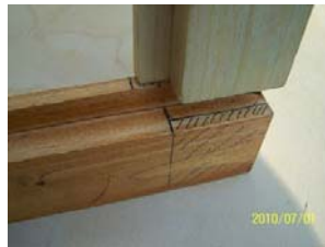
36. ábra. Ollós csapozás 2/3-ad aljazással csap berajzolása 36
