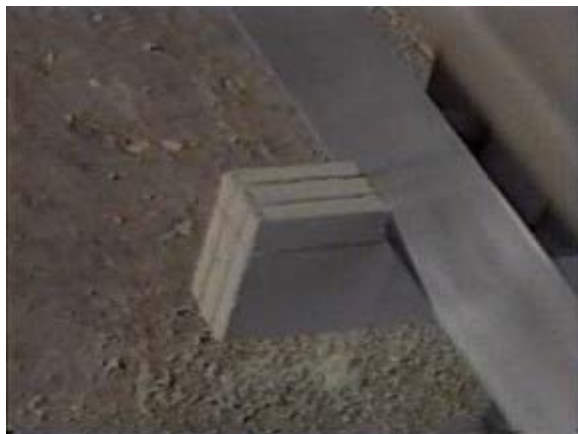
49. ábra. A szakáll lefűrészelése 49
