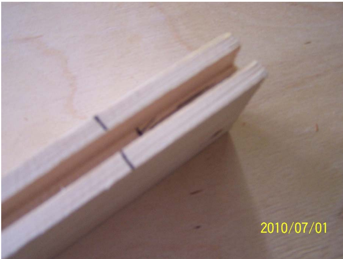
42. ábra. Ollós csapozás árkolással csaprés kihúzása 42
