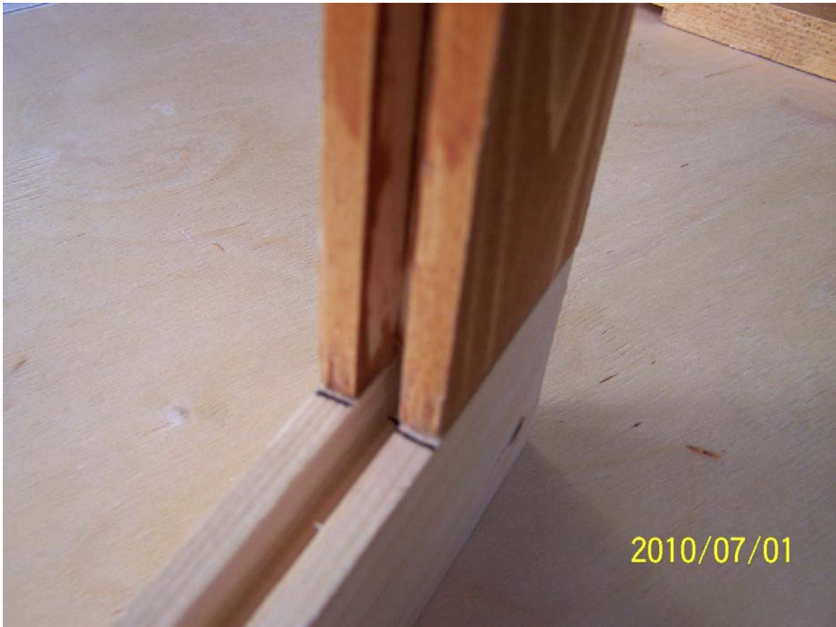
41. ábra. Ollós csapozás árkolással berajzolása 41
