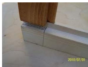
38. ábra. Ollós csapozás 2/3-ad aljazással csaprés berajzolása 38
