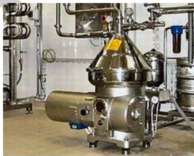
10. ábra Zárt főlözőgép
