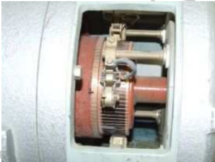
6. ábra. A kommutátor és a kefék elhelyezkedése
