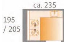
Bewegungsflächen bei verschiebbarer Toilette, die Wandtiefe der Sonderkonstruktion muss berücksichtigt werden.
