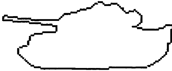
FIGURE 28. Courbe fermée d'un char, telle qu'utilisée pour le calcul des descripteurs de Fourier.
