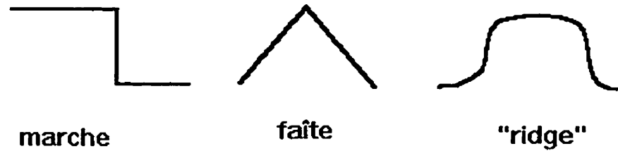
FIGURE 20. Types de bords considérés par l'approche de Canny lors de l'optimisation de sa méthode [27].
