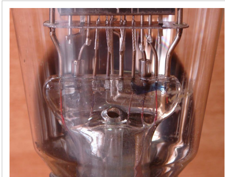
Quetschfußaufbau einer AL1
