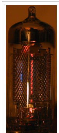
Blaue Lichterscheinung an der Anode (EF89)
