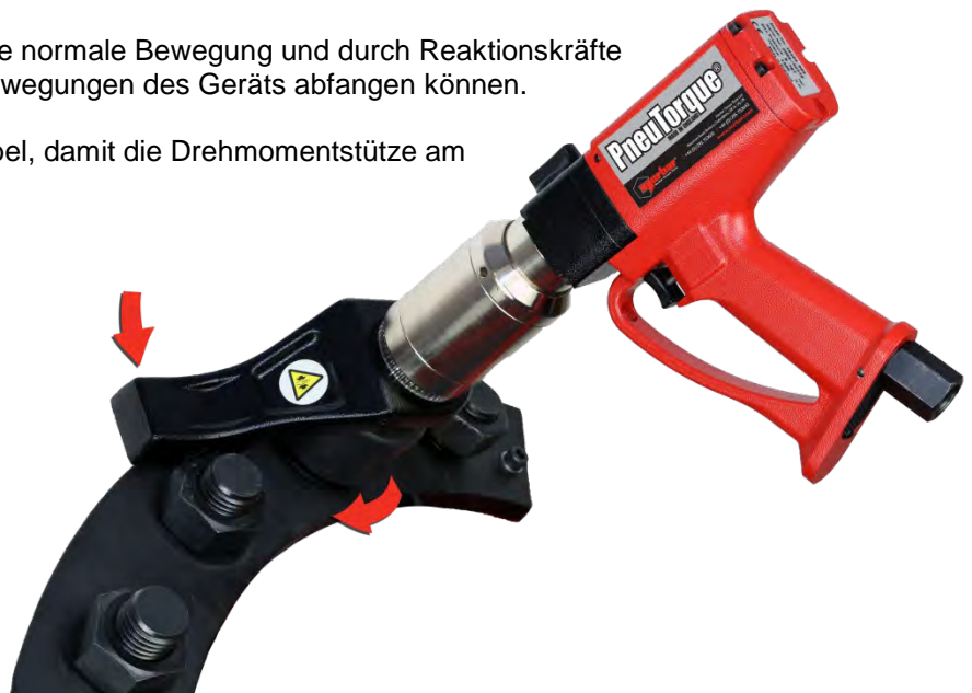
ABB. 12- Befestigungselemente Mit Rechtsgewinde Festziehen
