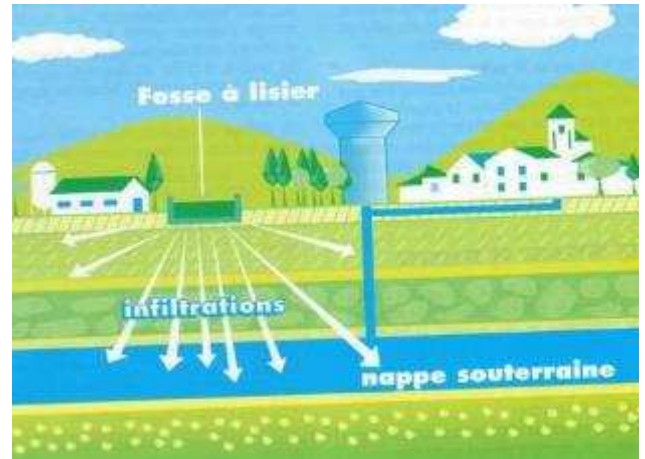
Figure 24. Contamination des eaux souterraines par une fosse à lisier fissurée
