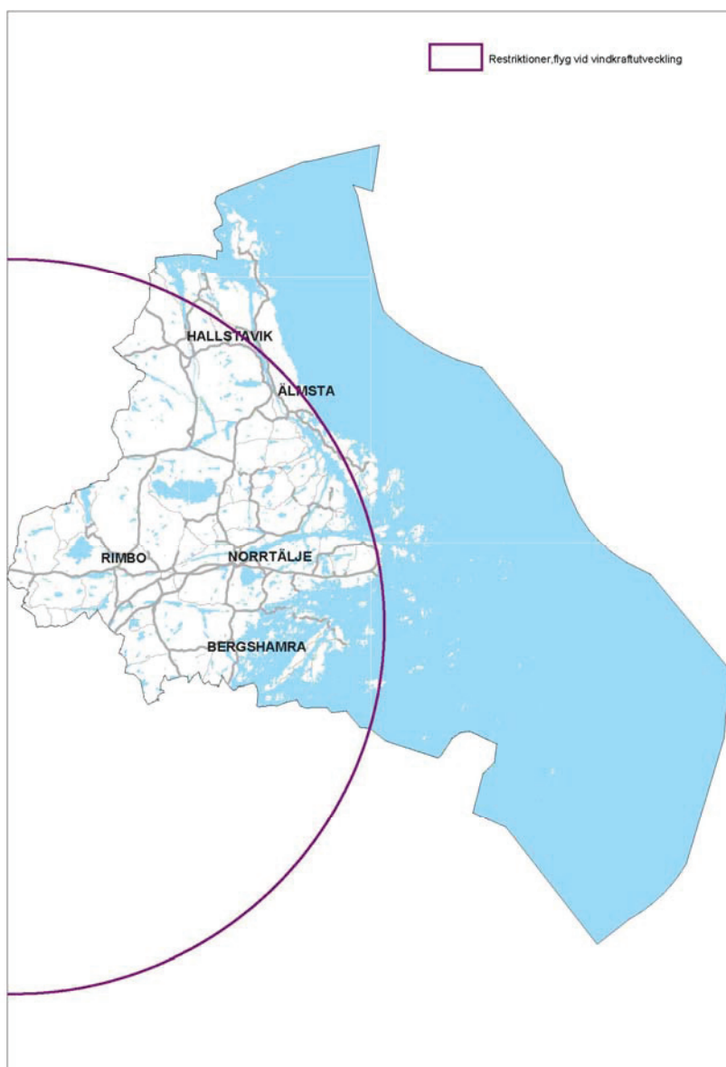
Figur 6.8 Kartan visar en radie av 55 km från Arlanda. Detta är ett exempel på hur den s.k. MSA-ytan kan se ut (Luftfartsverket har aktuella MSA-ytor för samtliga instrumentflygplatser). Inom detta område ska hindersfrihet råda för flygtrafiken. Det vill säga samråd med Trafikverket ska genomföras.
