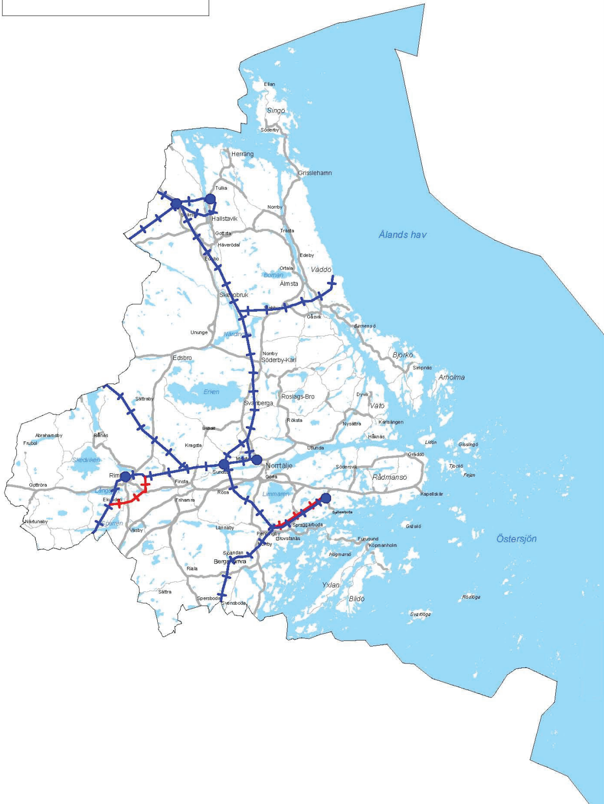
Figur 6.18 Befintliga och planerade kraftledningsstråk samt större transformatorstationer.
