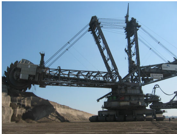
Abb. 4 Schaufelradbagger im Tagebau Garzweiler
