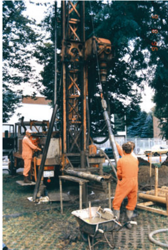
Abb. 17 Untersuchungen der Stadt Mönchengladbach zur Bergschadensthematik: Bohrungen des Geologischen Landesamtes 1996 am Rheindahlener Sprung zwischen Bell und Kohr
