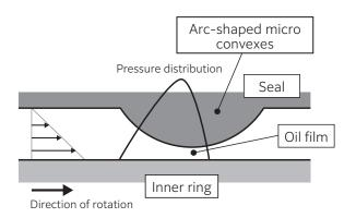
Fig. 5 Diagram of wedge film effect<sup>5)</sup>
