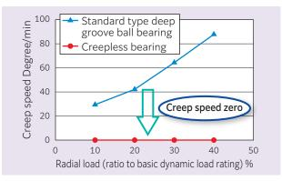
Fig. 11 Creep speed evaluation test results<sup>9)</sup>
