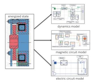
Fig. 20 Electromagnetic brake model<sup>21)</sup>
