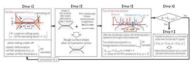
Fig. 3 Contact Stress Analysis Procedure<sup>7)</sup>
