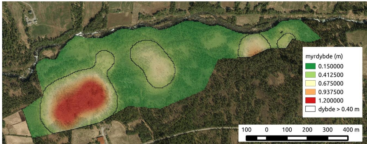
Figur 5. Estimert torvdybde for Sætremyrane. Areal med torvdybde over 0,4 m er innringet.
