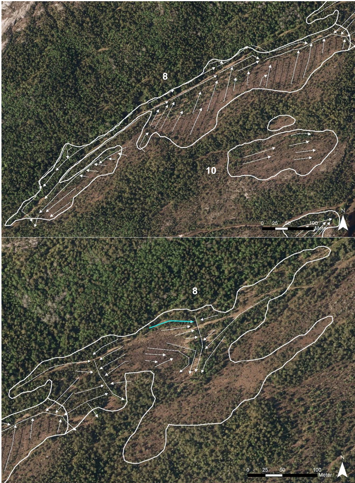
Figur 25. Myr 8 og 10 i Nyvassdalen, Hildremvatnet naturreservat. Øverst: Myr 10 og vestlige del av myr 8. Nederst: Østlige del av myr 8. Dreneringsretning i grøfter er angitt med hvite piler, og naturlig dreneringsretning med blå piler. Ortofoto fra 2012. Kilde: Norge i bilder.
