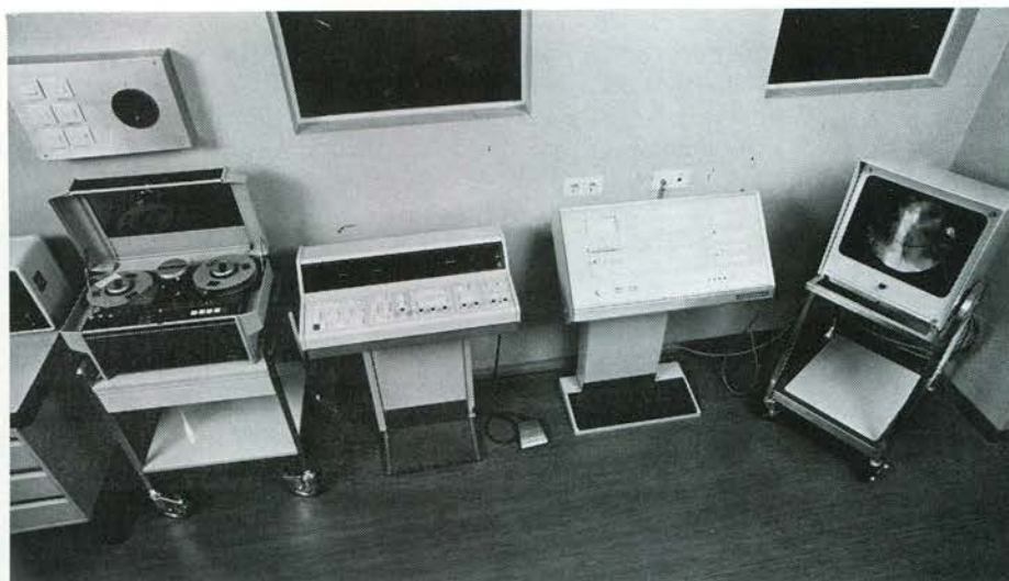
Afb. 7. Bedieningspanelen voor het maken van de opnamen met het schedelstatief. Rechts de televisie-monitor en links de videorecorder waarmee het televisiebeeld vastgelegd kan worden.
