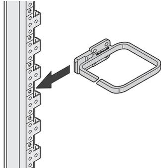
Im Varistar-Profil ist eine 25-mm-Rasterlochung in allen drei Dimensionen (Höhe, Breite, Tiefe) eingearbeitet. Dadurch entsteht höchste Variabilität bei der Befestigung von Ausbauteilen und Zubehör. So können z. B. 19"-Winkelprofile ohne zusätzliche Tiefenstreben in einem 600 mm breiten Schrank montiert werden. Das spart Kosten und bringt Stabilität auf der 19"-Ebene.
