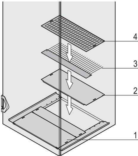
1: Bodenblech mehrteilig; 2: Abdeckblech; 3: Bürstenleiste; 4: Filtersatz
