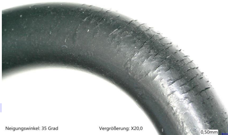
Abb. 18: Risse entstanden durch den Nacharbeitsschritt „Tempern“ (Örtliche Überhitzung durch defekten oder falsch eingestellten Temperofen)
