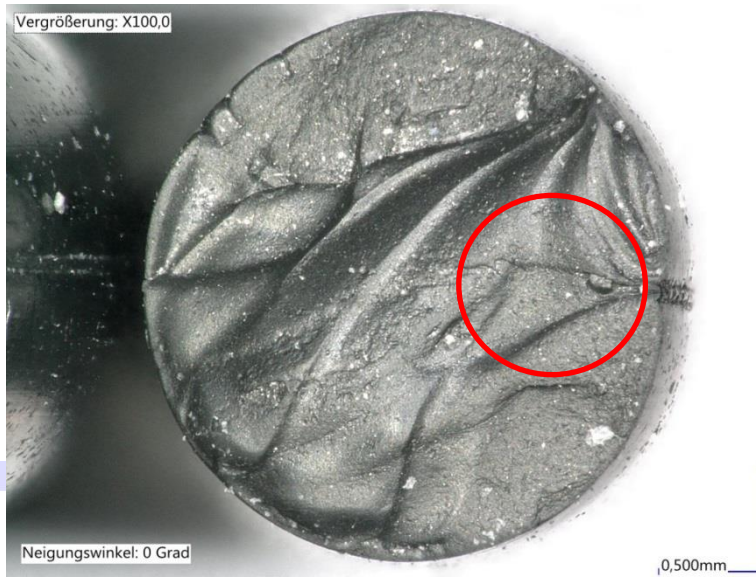
Abb. 6: Gerissener O-Ring wegen eines Vulkanisationsfehlers: Inhomogene, zerklüftete Bruchfläche
