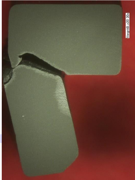
Abb. 16: Entformungsrisse an einem Dichtelement
