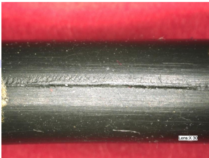
Abb. 12: Schrumpfriss an einem O-Ring
