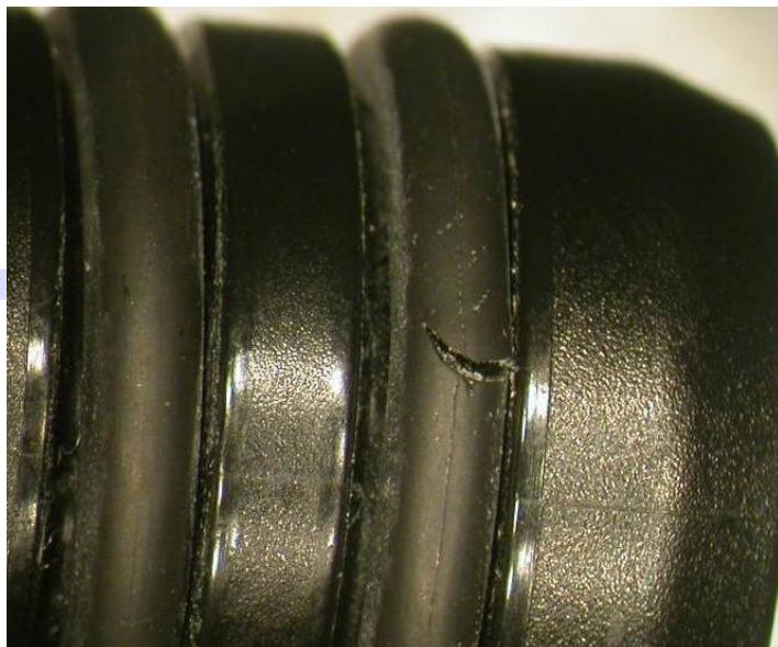
Abb. 2: Riss aufgrund eines Vulkanisationsfehlers, erkennbar am parabelförmigen Rissverlauf symmetrisch zur Formtrenneben
