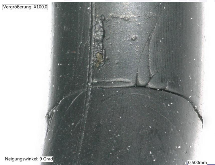
Abb. 7: Herstellungsbedingter Vulkanisationsfehler: Gerundeter Rissübergang (gleicher O-Ring wie in Abb. 4)
