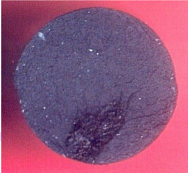
Abb. 11: Riss, ausgelöst durch Fremdmaterialeintrag
