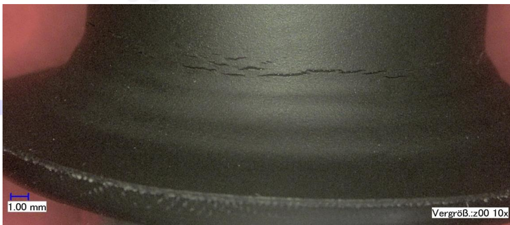
Abb. 20: Ermüdungsrisse an einer FKM-Membran
