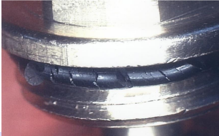
Abb. 19: Vormontierter O-Ring, der durch die Vorspannung und Ozon aus der Umgebungsluft nach mehreren Wochen Ozonrisse aufwies
