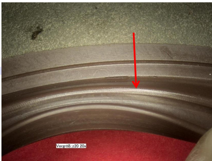
Abb. 15: Entformungsrisse an einer Formdichtung
