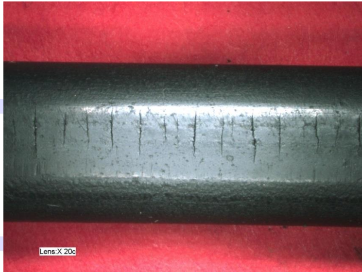
Abb. 21: Thermisch geschädigter O-Ring, komplett durchgehärtet, beim Biegen Risse an den Anlageflächen sichtbar
