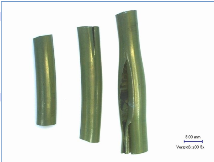
Abb. 1: Risse eines FKM O-Rings durch Übervulkanisation nach einer Druckverformungsprüfung von 168h / 200°C
