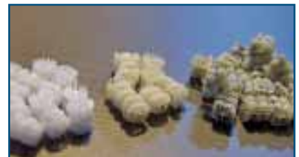
Biologische Oberfläche zur Ansiedlung der Mikroorganismen (links noch unbenutzte Biomedien, rechts mit angesiedelten Mikroorganismen).
