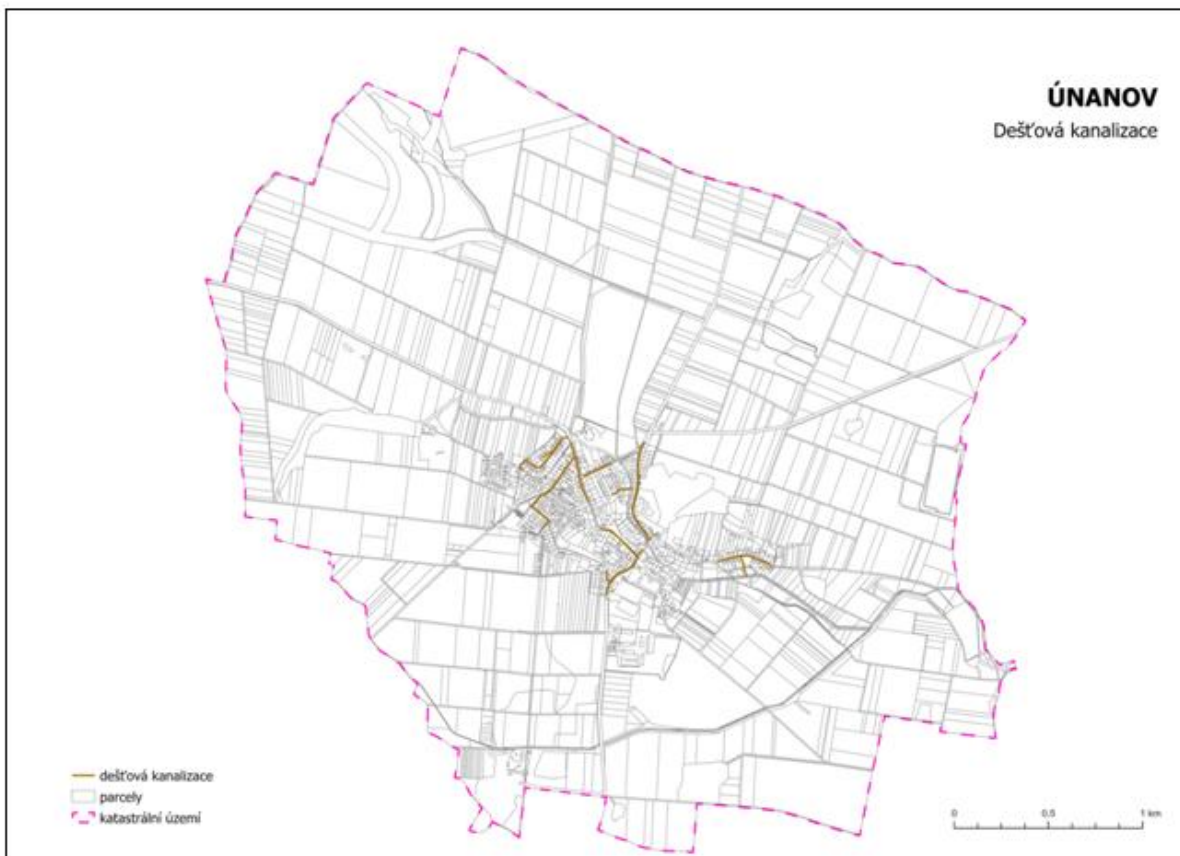
Obrázek 20 Dešťová kanalizace Únanov
