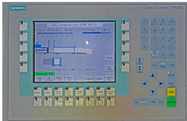
**Ballenpresse HSM VK 75 1600, Presskraft 75 t, Baujahr 1998, Antriebsleistung 55 kW, Einwurfschacht 1.600 x 720 mm**
