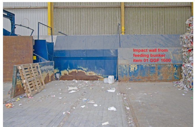
Detailbild Aufgabebereich des Schubbodens, rechts davon der Lager- und Aufgabebereich vom Aufgabebunker.
