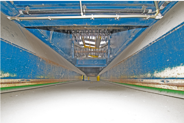
Austragsband Mittel- und Feinkorn, Pos. 05 GGF 1200, unter dem ersten und zweiten Deck des Scheibensiebes, Ansicht entgegen der Förderrichtung.
