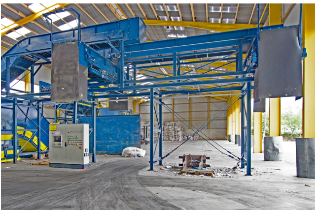
Detailansicht der Stellplätze für die vier Container oder zwei Walking Floor LKW.
