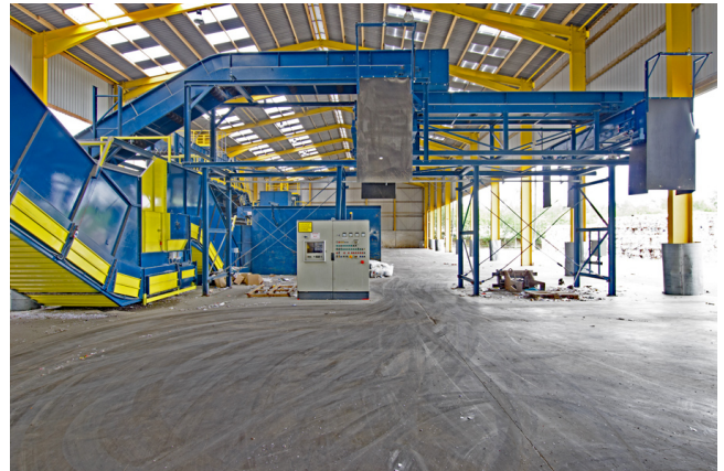
Seitenansicht automatische Beschickungsanlage für Container und Walking Floor LKW. Der Schaltschrank in der Mitte gehört nicht zum Lieferumfang.
