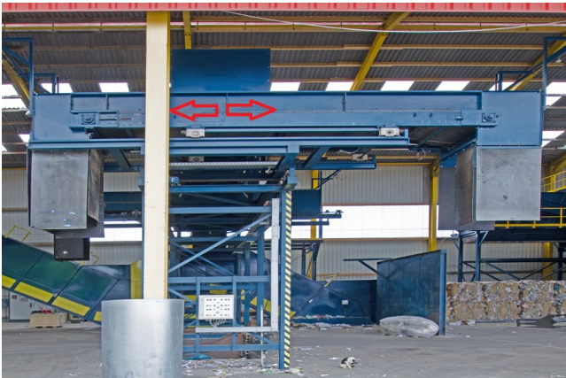
Detailansicht der seitlich verfahrbaren Querbänder, Pos. 13 / 14 GGF 1200. Hier erfolgt die Materialverteilung links und rechts von der Mittelachse.
