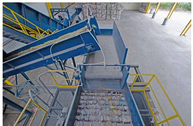
Übergabebereich vom 3. Austragsband Mittel- und Feinkorn, Pos. 07 GGF 1200, zum ersten Deck des Scheibensiebes, Pos. 08 SS 1600 (Fein-Korn).
