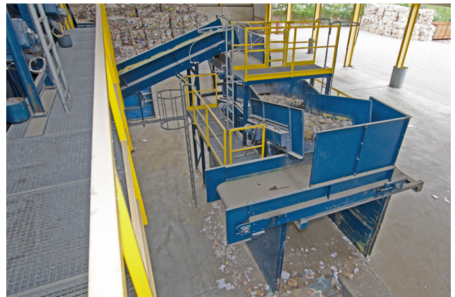
Ansicht Rückseite Austrag Feinkorn, unter den Scheibensieb, mit seitlichem Austrag des Überkorns (Mittelkorn), über das Austragsband Pos. 09 GGF 1200.
