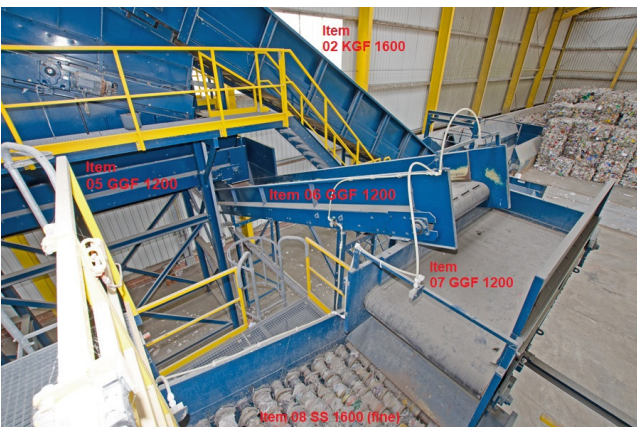
Links Austragsband Pos. 05 GGF 1200, mitte 2. Austragsband/Querband, Pos. 06 GGF 1200, rechts 3. Austragsband Pos. 07 GGF 1200, zum 2. Scheibensieb (Fein-Sieb).
