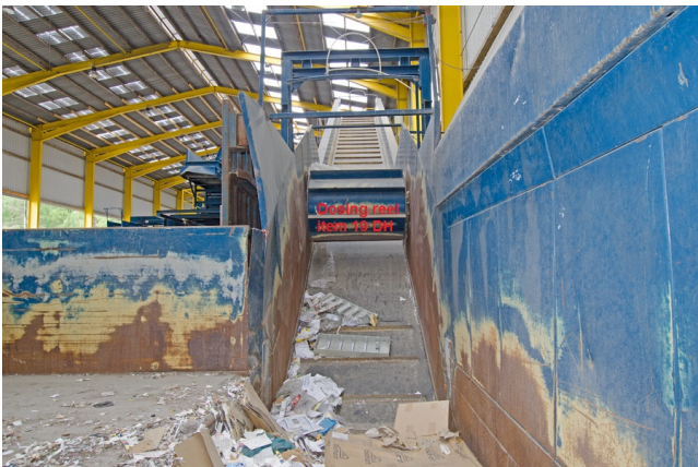
Steigband (Kettengurtförderband Pos. 02 KGF 1600) mit Dosierhaspel, Pos. 19 DH.
