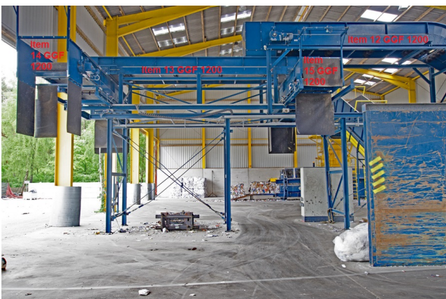
Querförderbänder, Pos. 14 GGF 1200 (rechts) und 15 GGF 1200 (links), zur Beschickung der Container und Walking Floor LKW links und rechts der Mittelachse.
