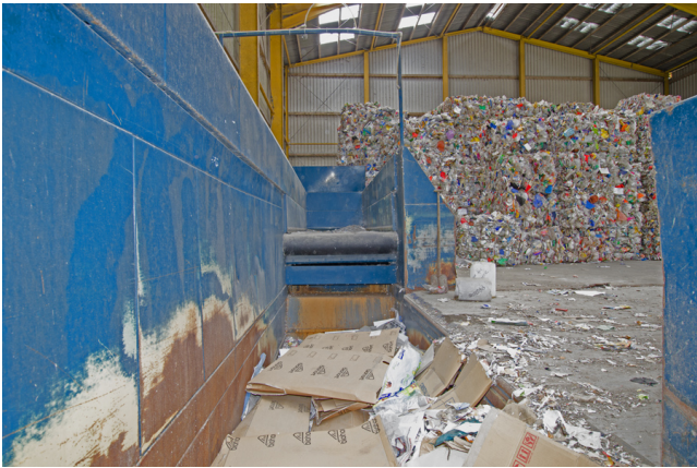
Pos. 01 GGF 1600, Aufgabebunker, oberflur, Nutzbreite 1.530 mm, Achsabstand 5.000 mm, Wandungshöhe 600 mm, Vorratsvolumen ca. 5 m³.
