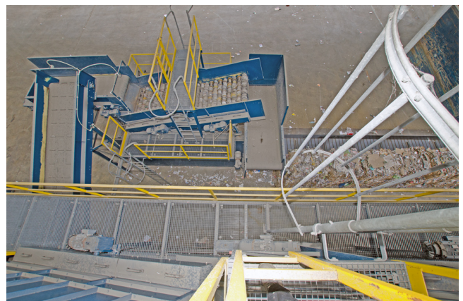
Übersicht Austrag Mittel- und Feinkorn vom ersten Scheibensieb, Pos. 03 SS 1600, zum zweiten Scheibensieb, Pos. 08 SS 1600 (Fein-Korn).
