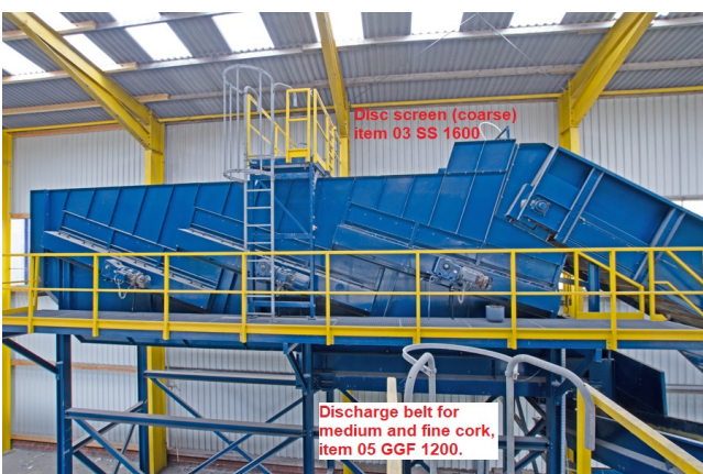
Scheibensieb (Grob-Sieb), Pos. 03 SS1600, darunter erkennbar das Austragsband für Mittel- und Feinkorn, Pos. 05 GGF 1200.
