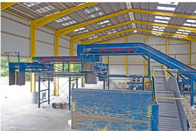
Aufgabe und Steigband zur Verladestation, Pos. 12 GGF 1200, Nutzbreite 1.130 mm, Achsabstand 14.200 mm, Steigung 30°.
