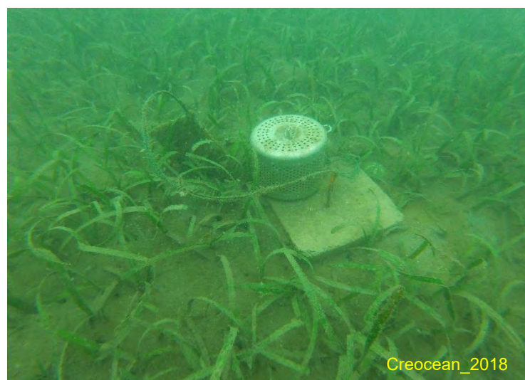
Figure 5 - Illustration du déploiement et de la relève des DGT et POCIS lors de la campagne 2018 et prélèvement SBSE en 2017
