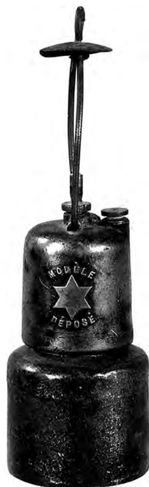
Lampe à acétylène, hauteur 19 cm, poids 1,8 kg
