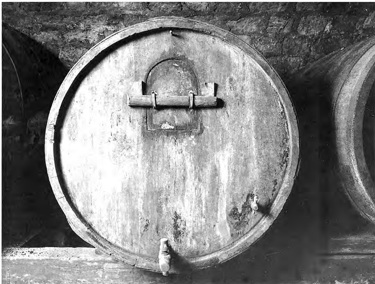
Un tonèl avec lo gaulièr (le cercle de tête), l'aure (la maîtresse douve), los cantèls (les chanteaux) et, de haut en bas, lo bespiralh , pour laisser rentrer l'air dans le tonneau, la trapèla qui permet à un homme de rentrer à l'intérieur pour le nettoyer, la canèla et le robinet piètre. La trapèla est maintenue fermée par une barre et des coins de bois ( la barra de la trapèla et los penches ).
