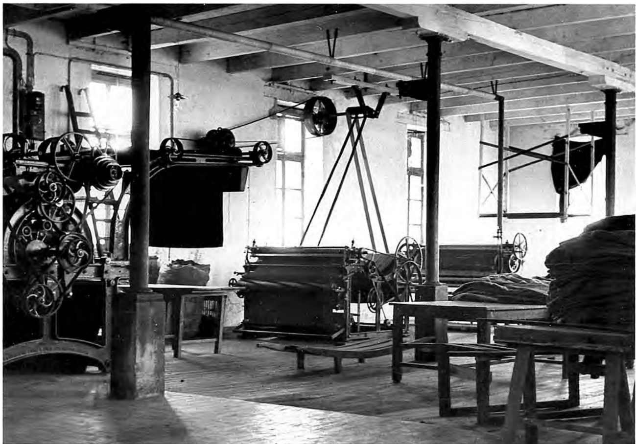
La salle des apprêts aménagés dans l'actuelle salle des fêtes, avec de gauche à droite, la laineuse, la tondeuse, la calendreuse
