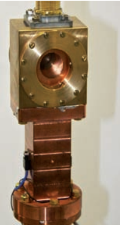
Abb. 1: Photo der Kavität zur Mikrowellen-Spektroskopie von antiprotonischem Helium am CERN-AD.
