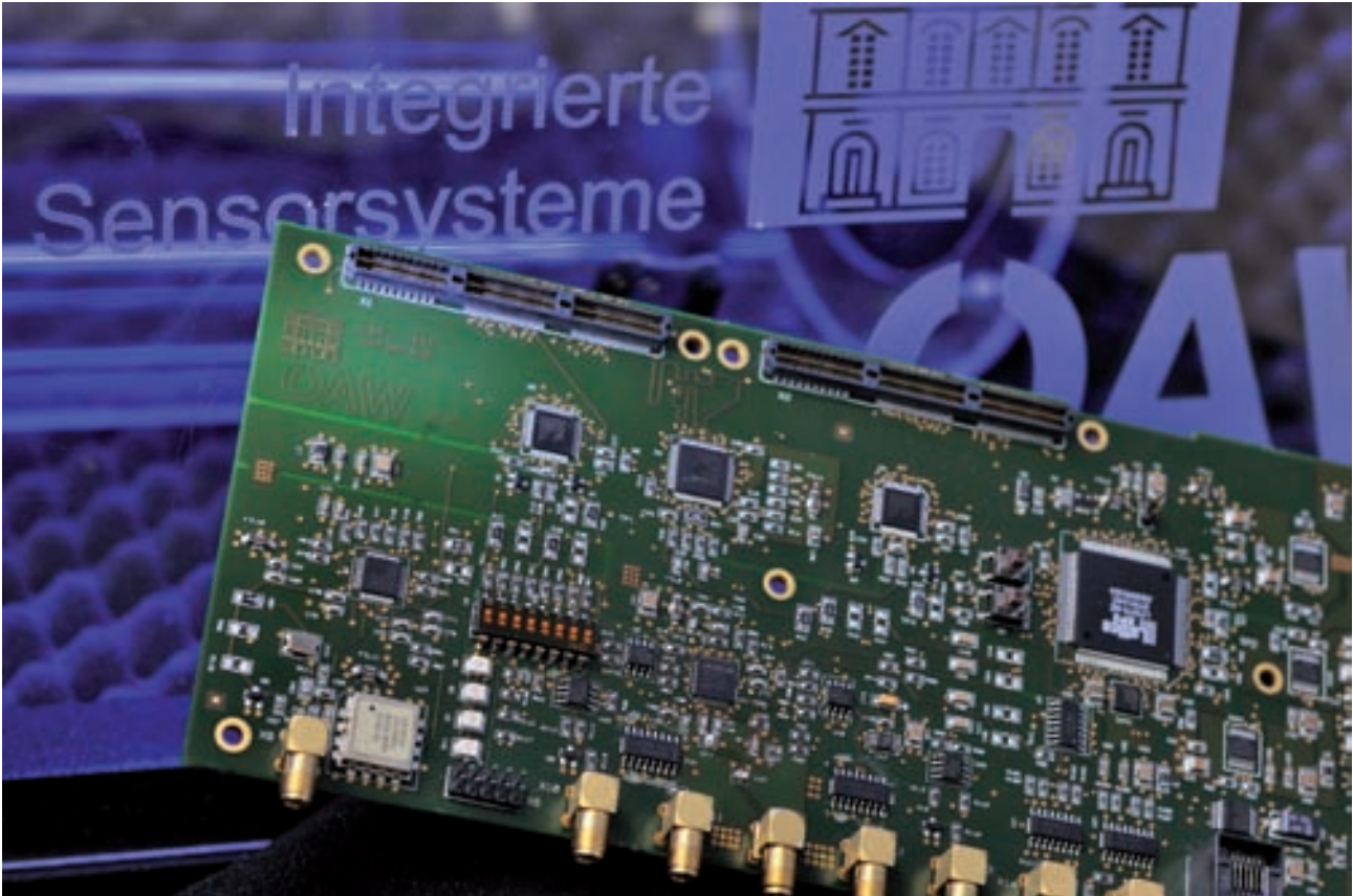
Abb. 3: Evaluierungsplattform für hochgenaue Uhrensynchronisation in drahtlosen und drahtgebundenen Computernetzwerken.
