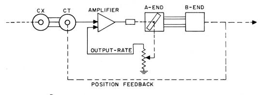
**B** VELOCITY FEEDBACK USING A POTENTIOMETER
