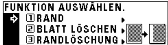
**4** Wenn eine andere Randbreite eingestellt werden soll, drücken Sie die "Cursor rechts"- bzw. "Cursor links"-Taste, um die gewünschte Randbreite zu wählen. Die Randbreite kann in Schritten von 1 mm auf einen Wert zwischen 6 mm und 18 mm eingestellt werden.
