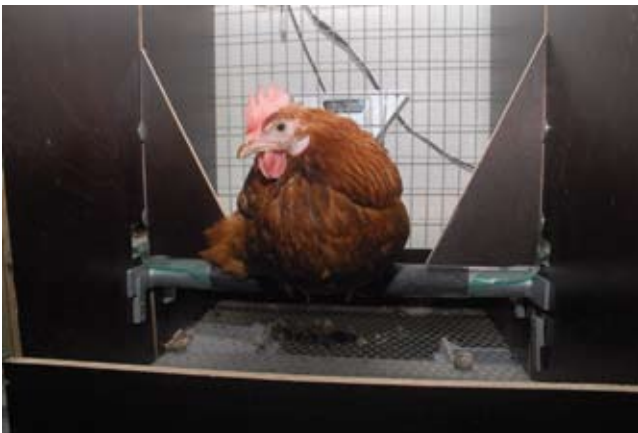
Abb. 2: Henne in der Versuchsapparatur zur Messung der Druckverteilung zwischen Brustbein und Fußballen während der Sitzstangennutzung.
