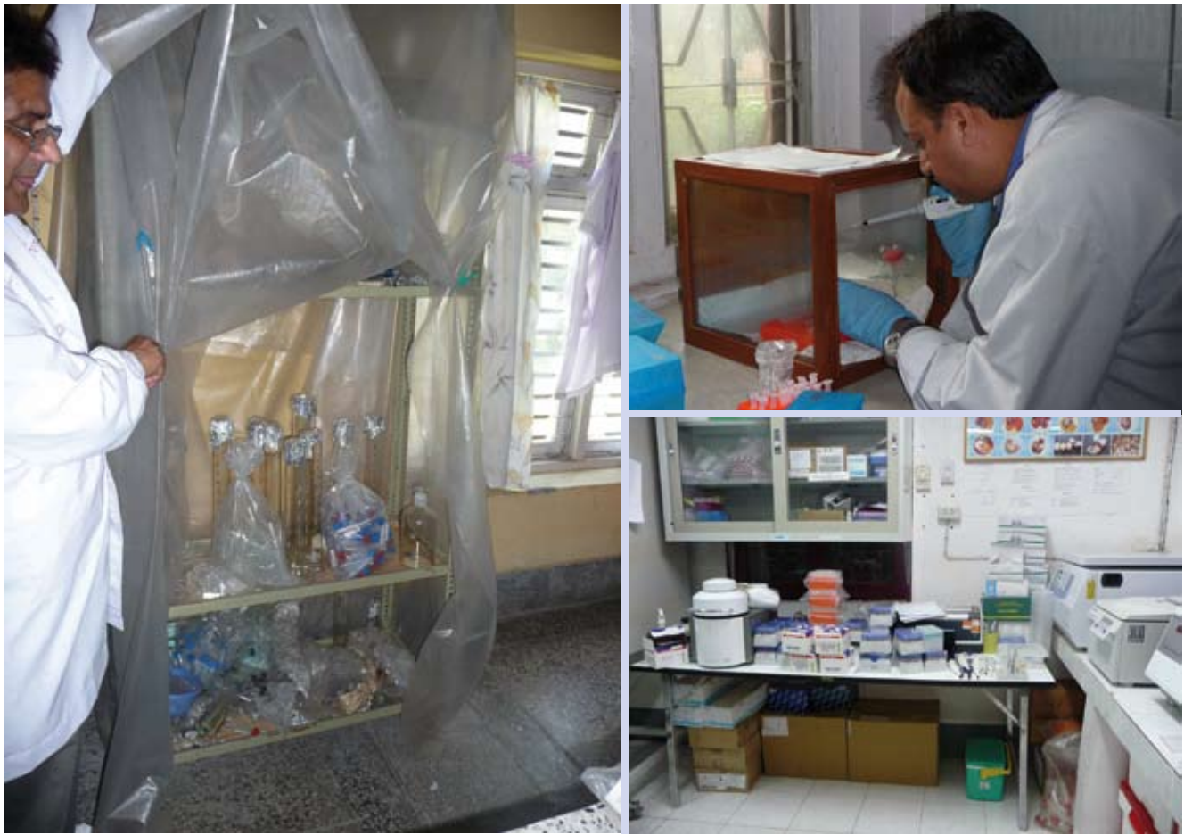
Abb. 1: Improvisationstalent gefragt: Aufbewahrung autoklavierter Glasgeräte in Pokhara, Nepal (links), Umfunktionierung Mikroskop-Box zur PCR-Box Kathmandu, Nepal (oben rechts), Labor Laos zu Beginn des ersten Einsatz (unten rechts).
