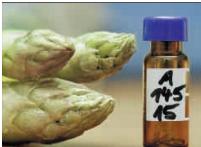
Abb.2: Mit Hilfe einer speziell entwickelten Probenvorbereitungstechnik werden aus etwa 400 g frischem Spargel 100 µl eines hochkonzentrierten Aromaextraktes gewonnen, der anschliessend mittels Gaschromatographie analysiert wird.
