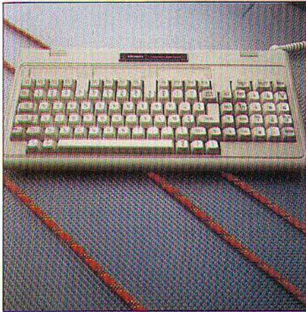
Le clavier du Tandy 1000 n'est pas une copie servile de celui de l'IBM PC. Les touches de fonction sont disposées horizontalement.
