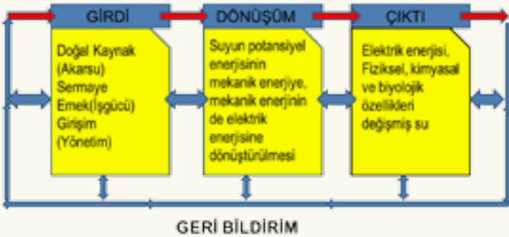
Şekil 2. Girdi-Dönüşüm-Çıktı Modeline Göre HES'lerin Çalışması
